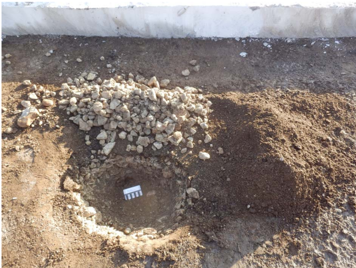
Joonis 11. Vaade väljaraide alusele surfidele, kus näha bituumenliiv ja killustik
