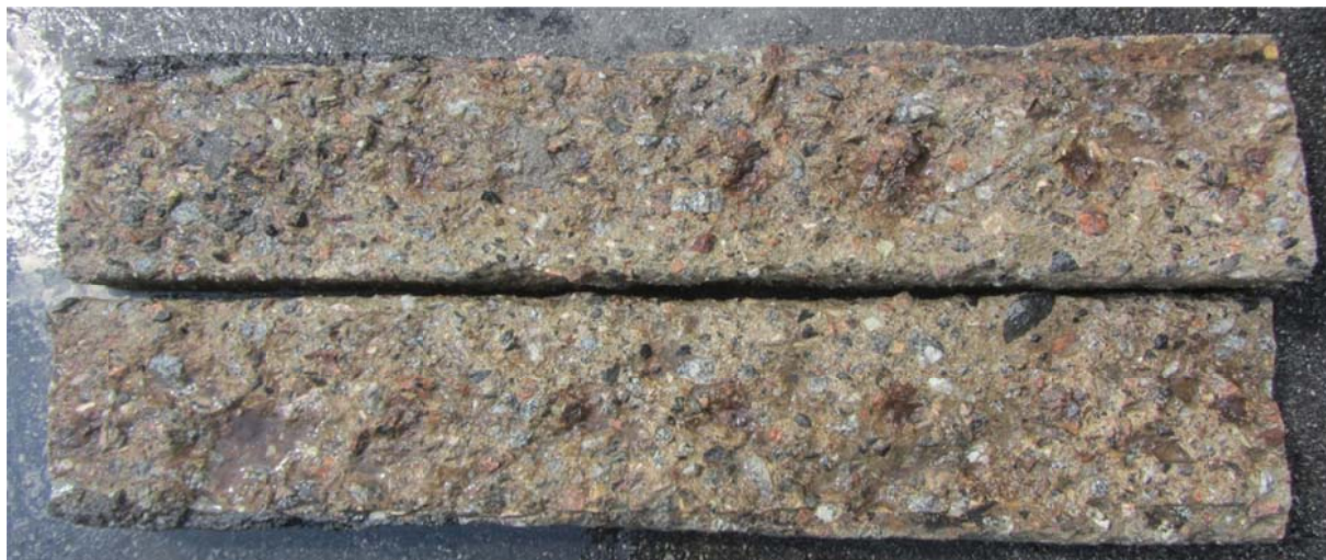
Foto 10. Puhtaks pestud halvasti säilinud vuuk, näha on armatuur
