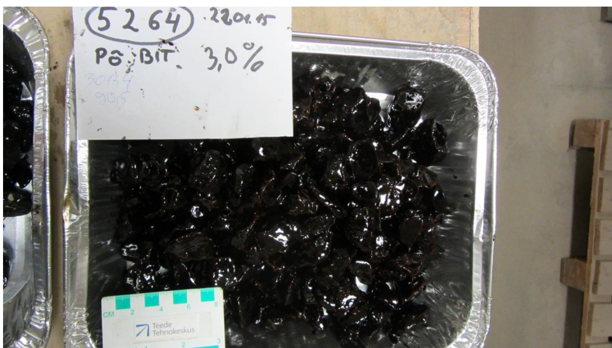
Variant nr 3 aherainekillustikuga. Bituumeni kiht suhteliselt paks.
