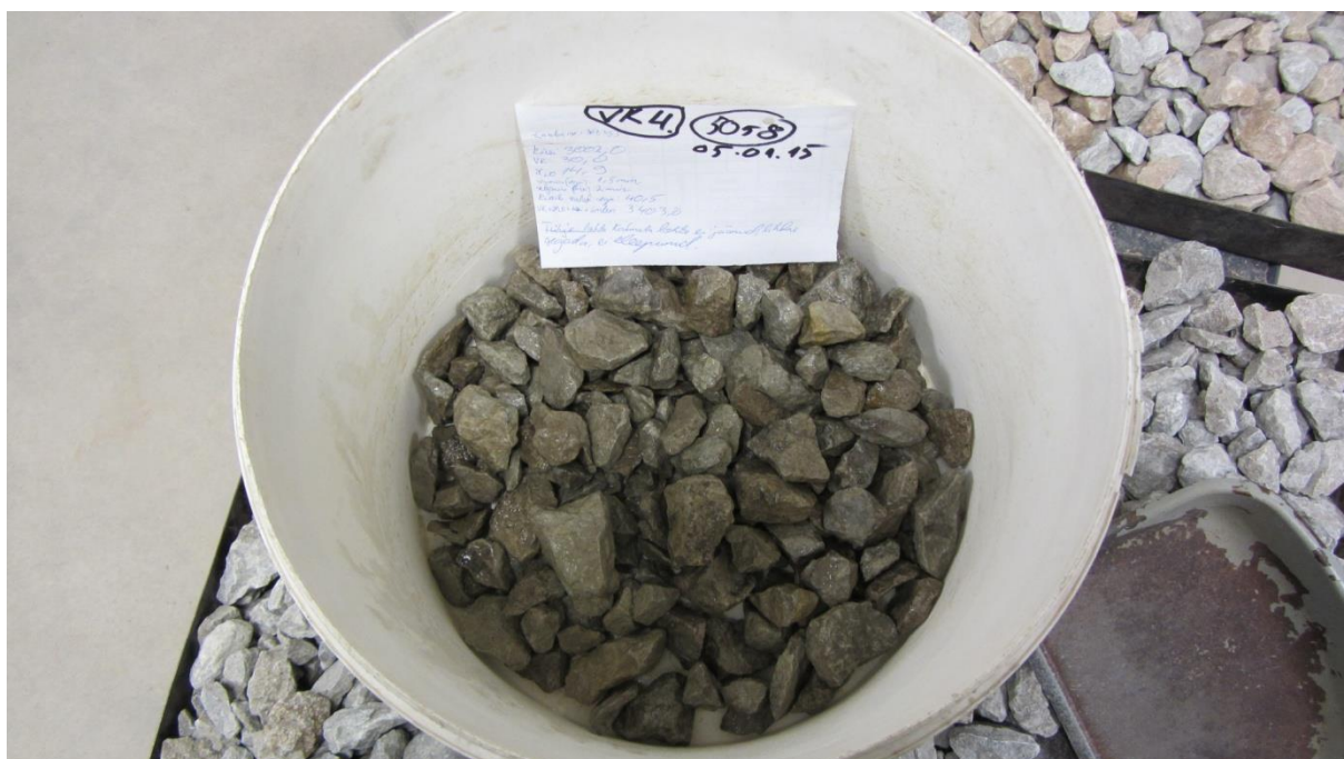
Variant nr 1 aherainekillustikuga, vesiklaasile ei segatud juurde vett.
