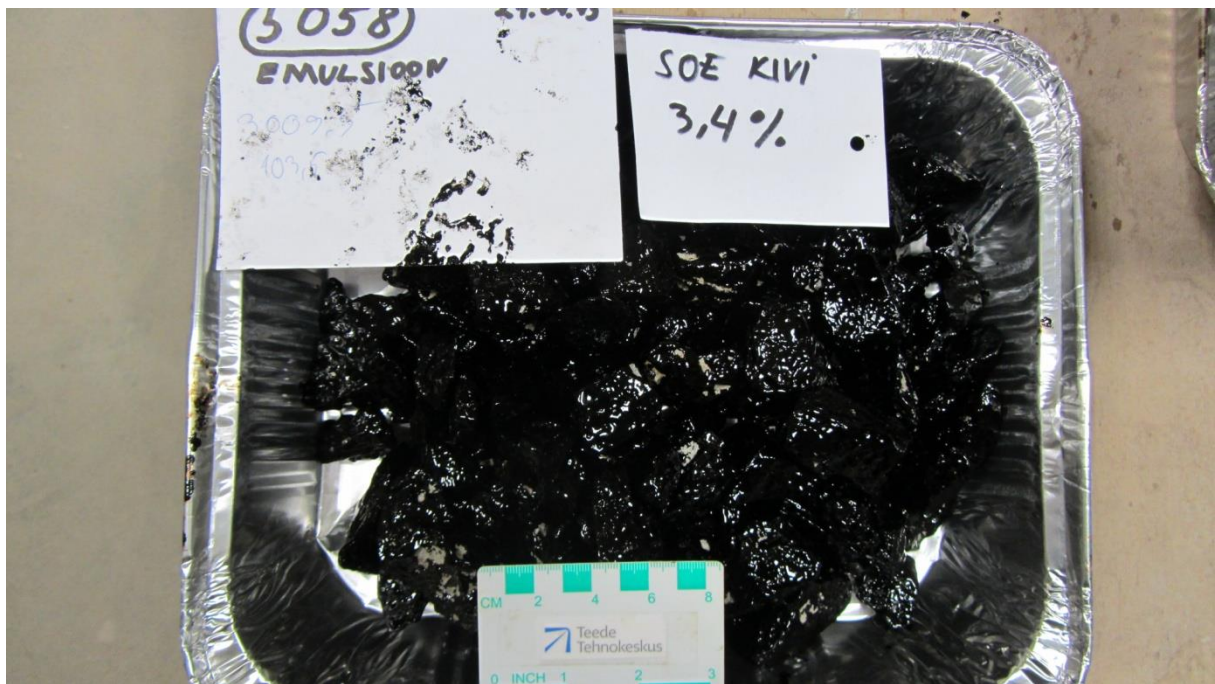
Variant nr 3 referentskillustikuga. Kividel olev kiht paks. Kohati katmata laigud.
