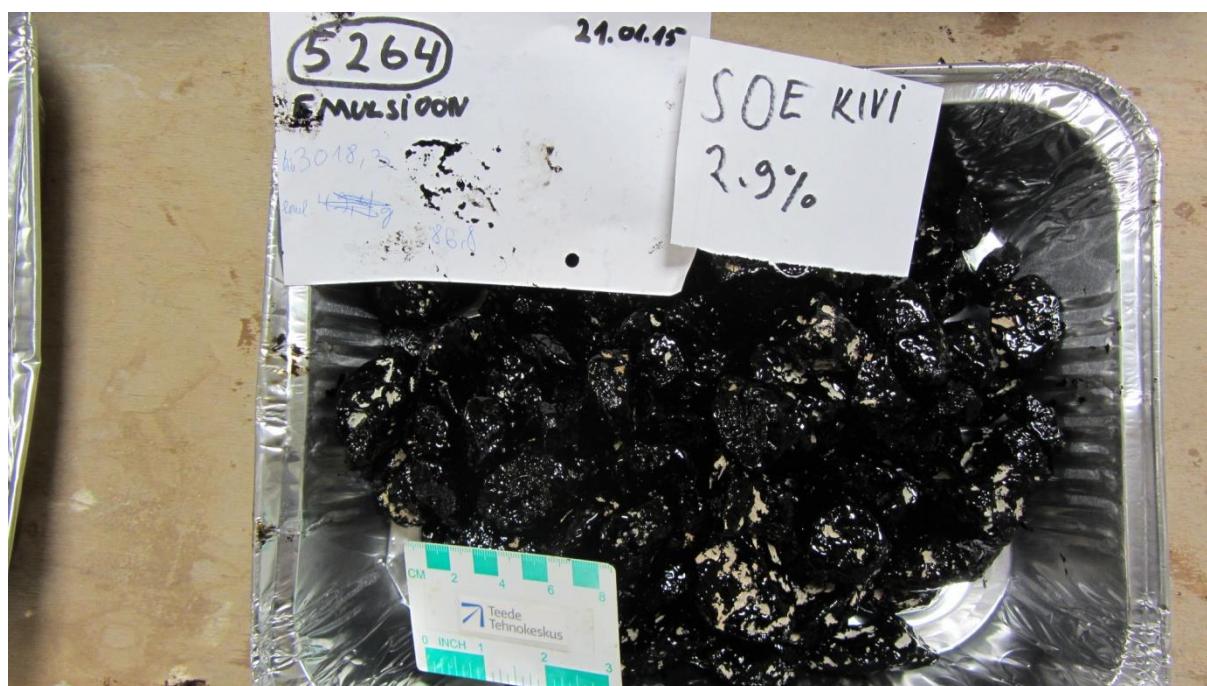
Variant nr 3 aherainekillustikuga. Emulsiooni kiht väga paks, kuid siiski mõned katmata lohud.
