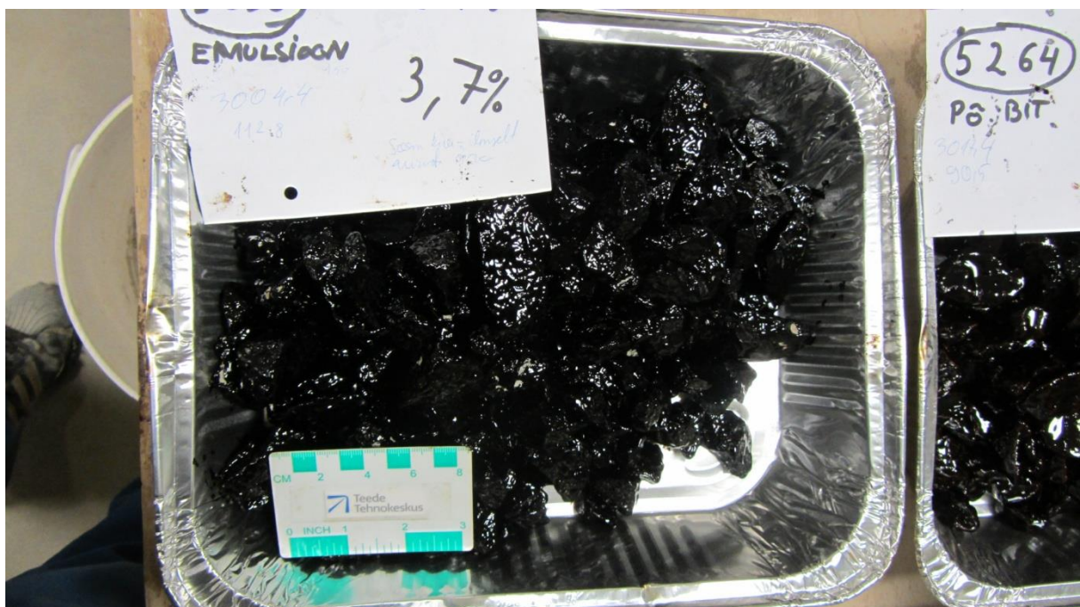
Variant nr 1 aherainekillustikuga. Kohati katmata laigud. Segamine ja katmine oli lihtsam tänu vähestele plaatjatele kividele.
