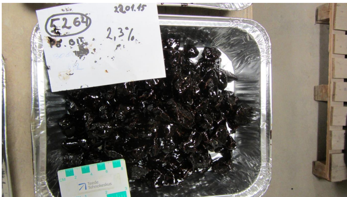
Variant nr 3 aherainekillustikuga. Bituumeni kiht suhteliselt paks.
