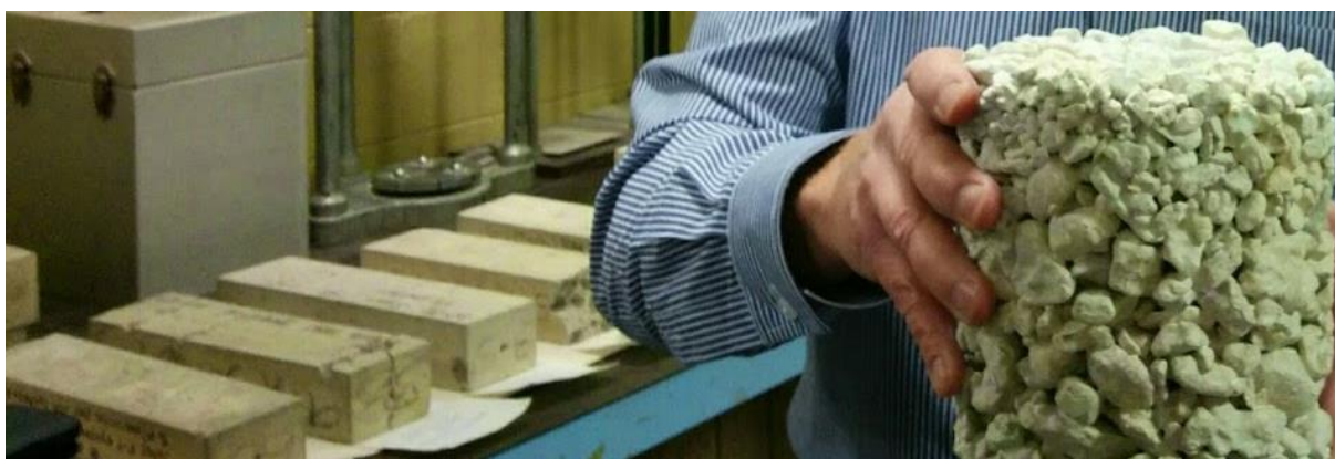
Foto 6. Esiplaanil katsetöö proovikeha seotud lubjakivist drenkillustikuga, vasakul laual külmakindluse proovikehad pärast katsetamist – mõõdetakse pikenemist
