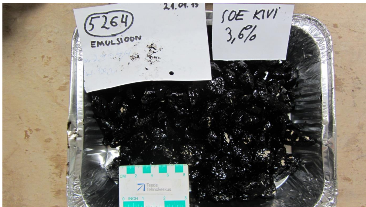
Variant nr 2 aherainekillustikuga. Katvus nähtavalt halvem, kui 3,6% puhul.
