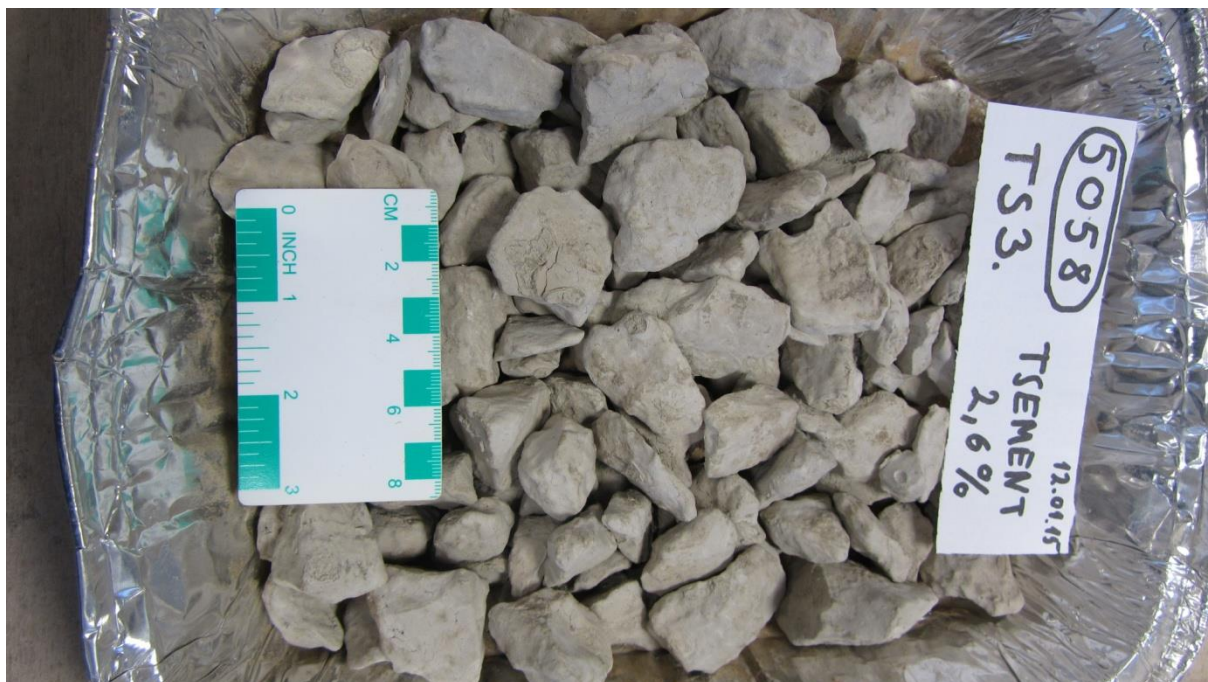
Variant nr 1 aherainekillustikuga. Kivid olid kaetud, kuid mitte piisavalt.
