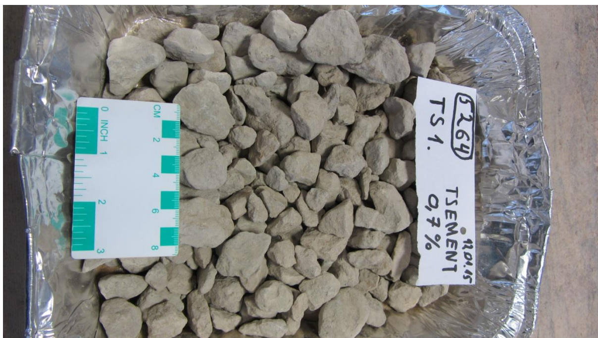
Variant nr 2 aherainekillustikuga. Kivide katvust tsemendiga oli hea.
